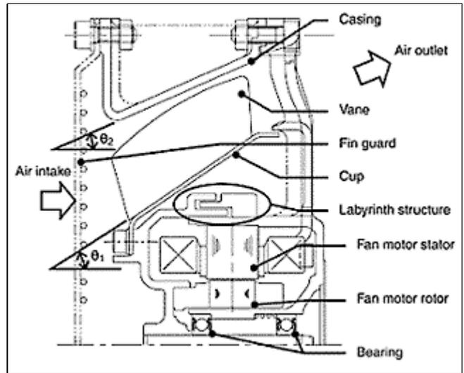
fig. 3 Cross-flow fan structure
